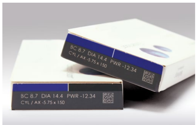
Verpackungskennzeichnung durch Farbabtrag
