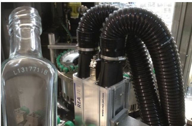
Glaskennzeichnung mit CO 2 Laser IP65
