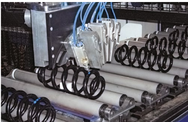
Kennzeichnung von Stahlfedern zur Typenklassifizierung
