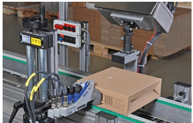
Etiketteneinsparung durch HR Direktdruck auf Kartons
