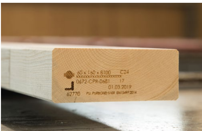
Holzkennzeichnung mit CO 2 Laser
