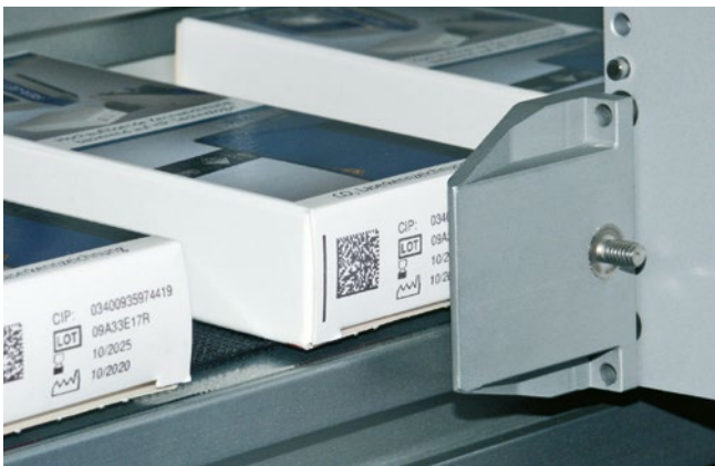
Faltschachtelkennzeichnung mit Data Matrix Code
