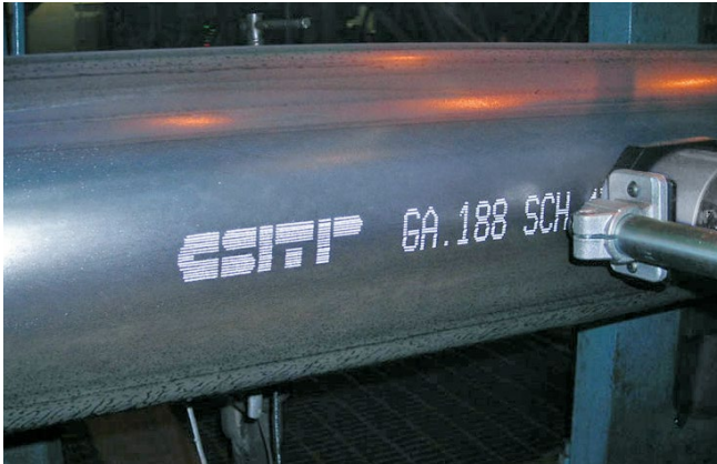
Kennzeichnung von Rohren (Stahl, Kunststoff etc.)
