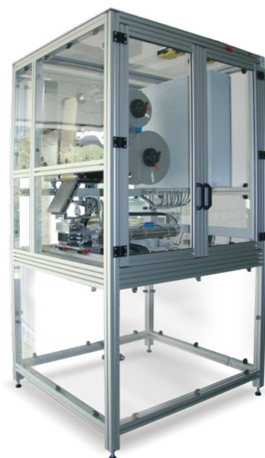
Paletten Etikettierung nach CCG/GS1 Konformität, 1 Stopp für 2 Seiten
