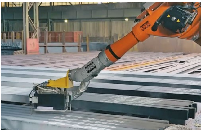
Stahlknüppelmarkierung Signierblock an Roboter
